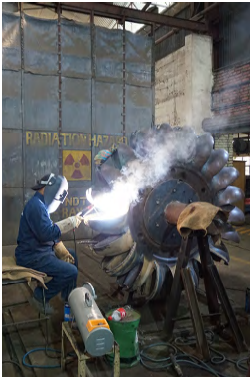
Det sveises på nytt metall for å reparere erosjonsskadene. Mye arbeid med fiksing av eroderte løpehjul. Det gjaldt å ikke stirre for hardt på de.
