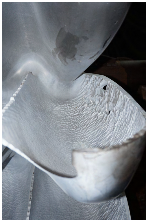
Peltonbøtte med store erosjonsskader. Her er det faktisk gått hull i bøtta, og man kan stikke en finger gjennom
