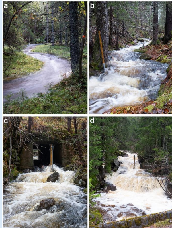
Figur 3: Vannstand under høstflom i Stårsjøbekken. PVC-rørene inneholder pH-logger (t.v.) og trykklogger (t.h.).
