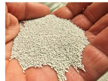
Figur 3. Nærbilde av krystallinsk struvitt produsert ved Hias IKS. Kilde: Struvitt - Hias IKS
