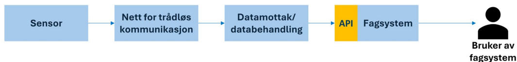
Figur 1. Overordnet skisse som viser hovedkomponenter i en forvaltningsløsning for behovsstyrt slamtømming basert på IoT-sensor for nivåmåling.
