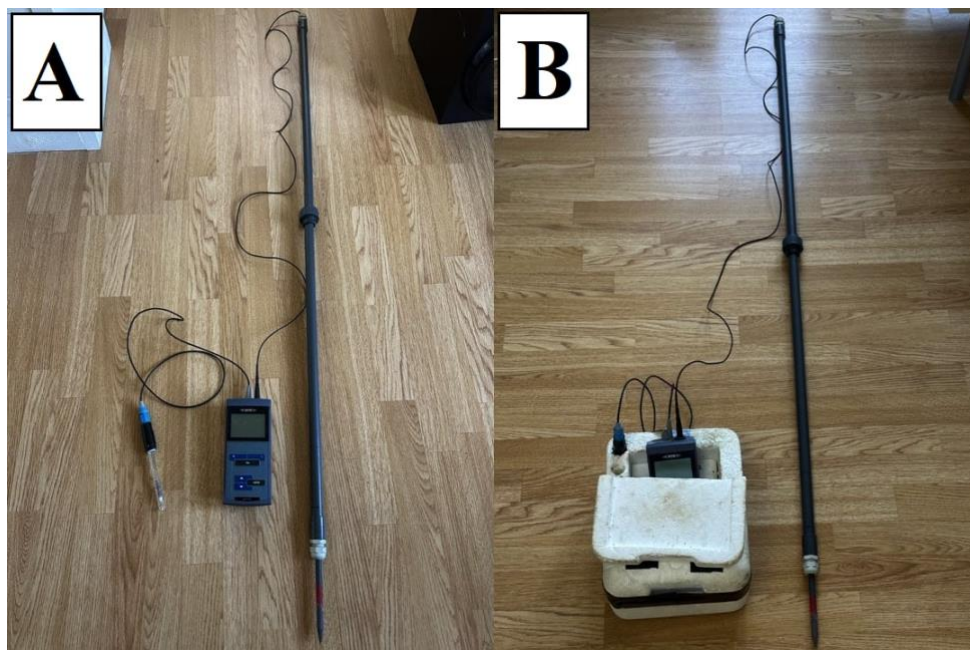
Figur 1 Viser de tre hovedkomponentene i apparatet. Fra venstre i foto 1a: referanseelektrode, voltmeter og sonde. Figur 1b viser komponentene plassert i "båten".
