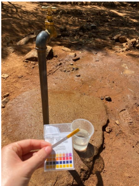
Testing av pH på en av skolene som brukte regnvann.
