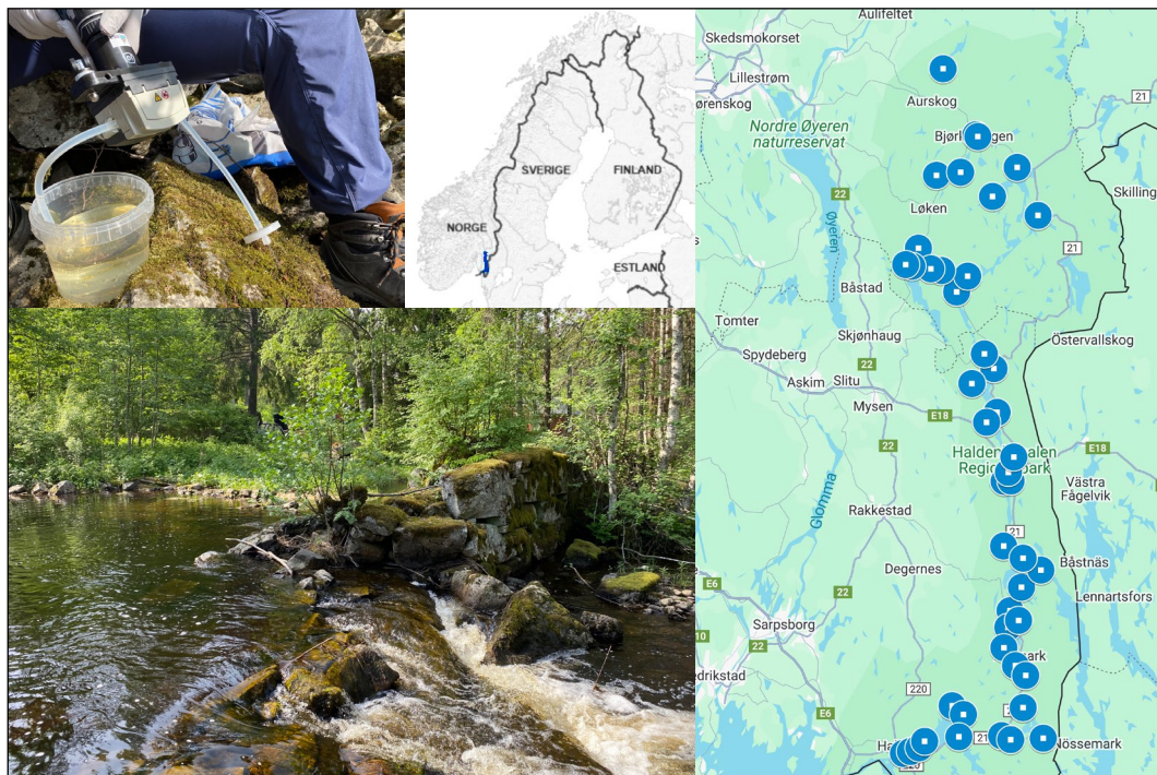
Figur 1. Oversikt over lokalitetene i Haldenvassdraget som det ble tatt prøver for miljøDNA. Bildet øverst til venstre viser oppsettet for hvordan vann ved hjelp av en peristaltisk pumpe presses gjennom et filter. Bildet nede til venstre viser lokalitet 1 (utløp Floen/Ulviksjøen) der prøvene ble tatt nedstrøms stryket, noe som skulle sikre at vannet var godt blandet.
