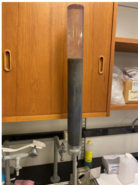
Figur 2. Sylindrisk sedimentprøvetaker med ca. 30 cm sedimentkjerne (foto: Jennifer Holmelid).
