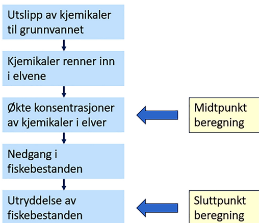
Figur 2. Sammenheng mellom midtpunkt beregninger og slutt-punkt beregninger
