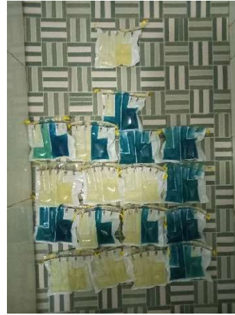
Samling fra mikrobiologiske prøver fra Kabusgo og Kasingo. En fargeendring fra gul til blå betyr tilstedeværelsen av E.coli. Ved hjelp av et statistisk skjema beregnes most probable number/100mL. Til sammenligning ligger dagens field blank øverst
