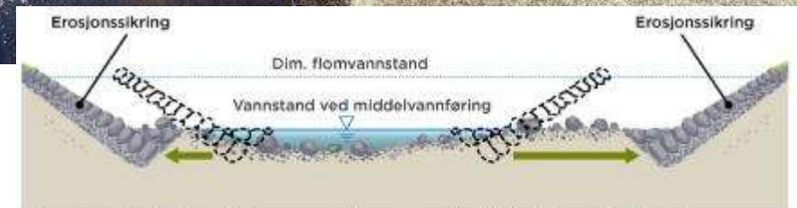
Eksempel for tilbaketrekking av erosjonssikring fra NVEs sikringshåndbok. 4
