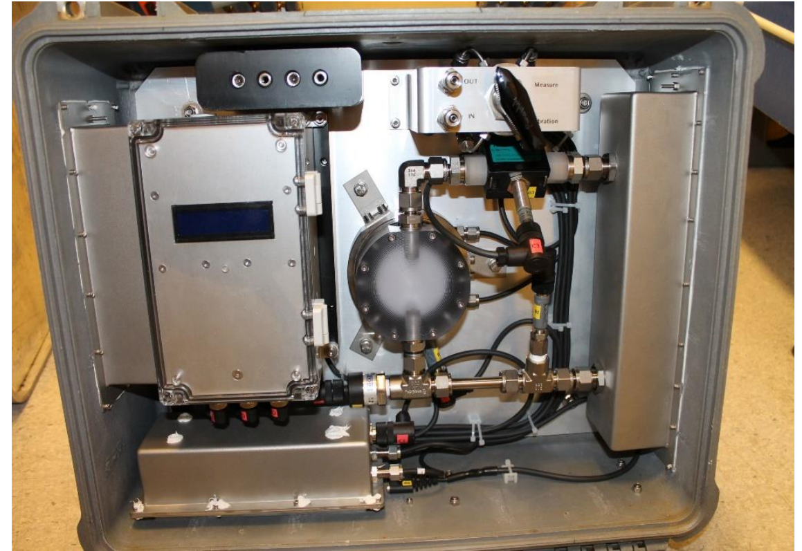
Franatech-NIVA pCO2 sensor med membran og NIR detektor
