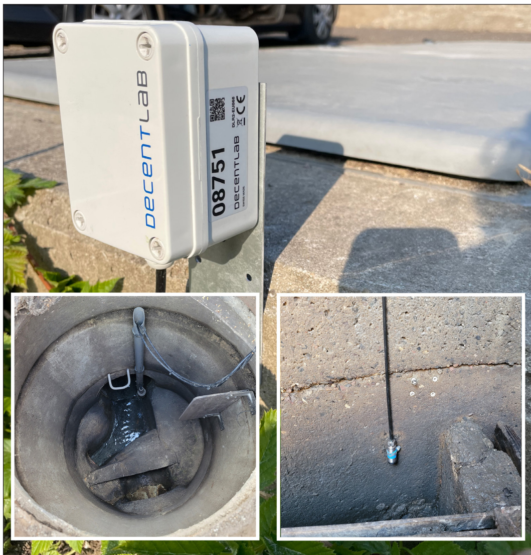
Figur 3. Eksempel på IoT-logger for overvåking av overløp fra kloakk. Loggeren er batteridrevet og data sendes online til NIRAS' varslingsserver hvor de behandles i henhold til de konkrete forholdene på badeplassen.
