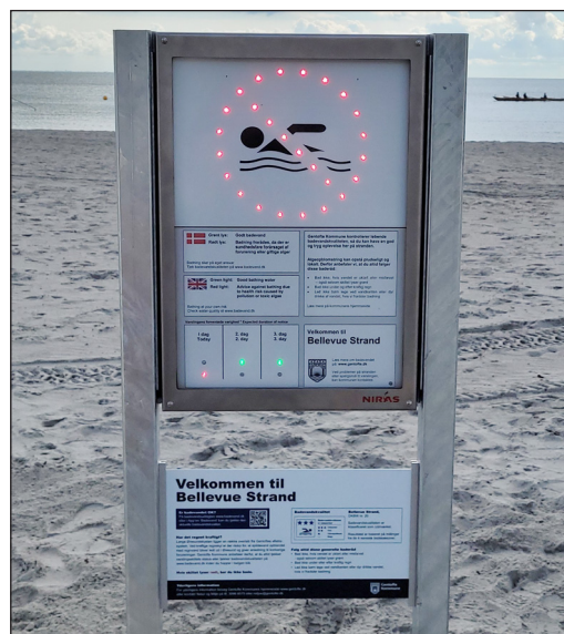
Figur 1. Varslingsskiltet "FORUM". Skiltet brukes som interaktivt plattform for å varsle om kortvarig forurensning på badeplasser slik at badegjester blir møtt med rettidig informasjon på stedet, og kan nyte en trygg og bekymringsløs dag på stranden.
