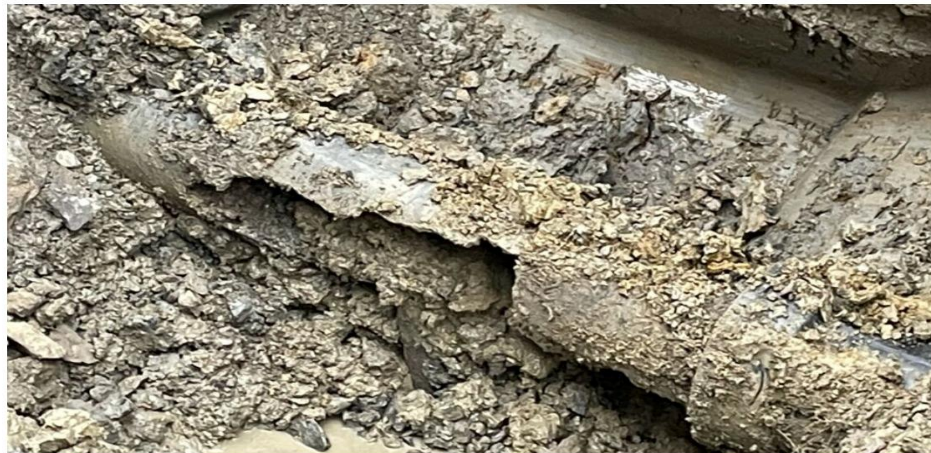
HOLDT 124 ÅR: Støpiørret fra 1888 som sprakk og lagde skøytebane på Majorstua natt til 8. januar. Temperatur: 5 kuldegrader. Foto:
