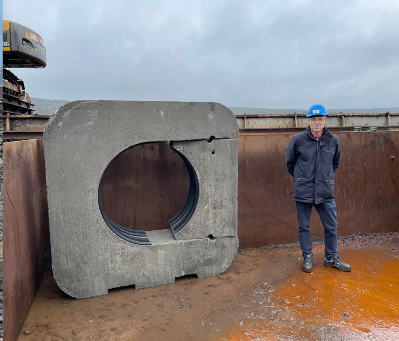
Daglig leder Bjørn Hånde v/NFRA, med luftfelle Ø2000 og belastningslodd Ø1000.
