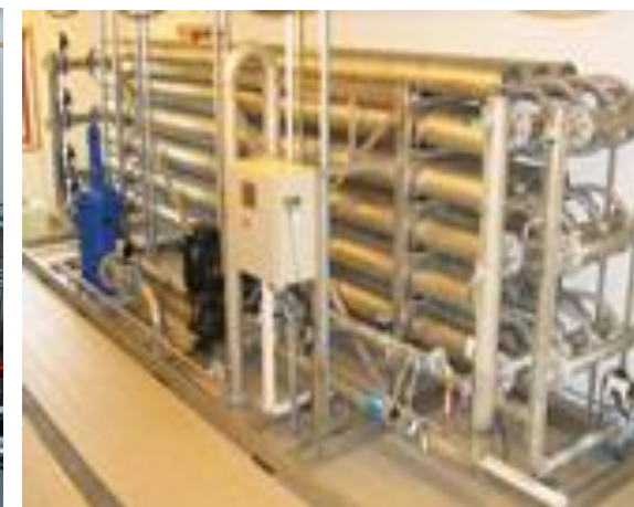
Nanofiltrering Ca 110 anlegg
