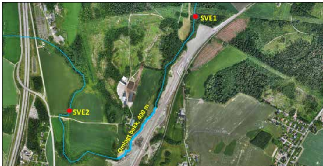
Figur 10. Fiske- og bunndyrstasjoner i Sverstadbekken oppstrøms (SVE1) og nedstrøms (SVE2) omfattende grave- og anleggsarbeider for omlegging av 400 m bekk samt bygging av nytt dobbeltspor i perioden 2009 -2011.
