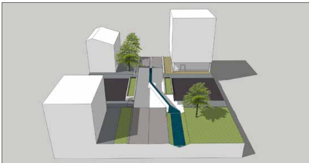
Figur 5. Flomvei passerer kryss under og over bakken. Oppe t.v. hverdagsituasjon der vadi håndterer inntil 5-års hendelsen. Oppe t.h. situasjonsbilde ved 200-års hendelsen. Stort bilde nede viser vannet i kulvert under asfalten (egen illustrasjon)
