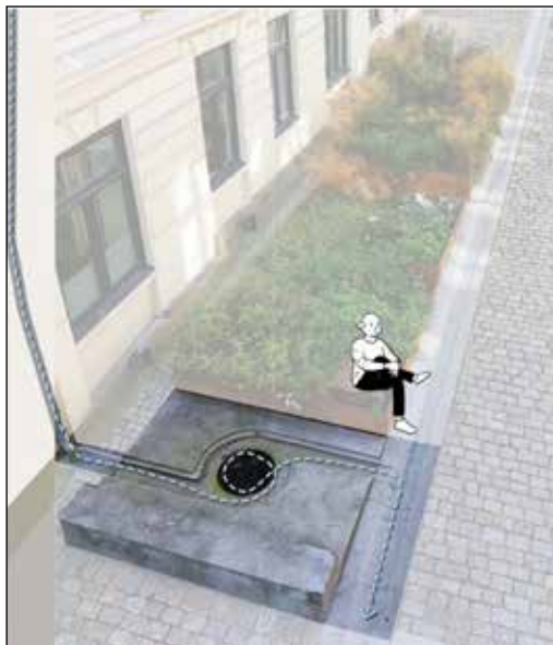
Figur 7: Spesialdesignede granittelementer ble installert i Deichmans gate som del av opprustningen i 2016. Elementene var ment å synliggjøre vannet under nedbørsperioder og invitere til aktiv bruk og lek. Samtidig skal de forsinke og lede overvannet trygt langs gateløpet. (ibid)
