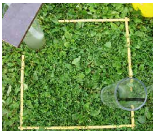
Figur 3: Oppsett av infiltrasjonsforsøk på en forsøksrute på 60 cm*60 cm. Plassering av MPD-rør i forhold til Dobbelring-infiltrrometer.
