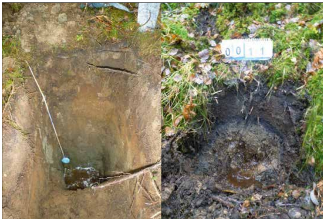
Figur 7. Bildene viser lokalitet 1 til venstre (Fig.7a) og lokalitet 11 (Fig. 7b) til høyre. På lokalitet 1 ble det gravd ned til grunnvannet (ca. 60 cm), mens på lokalitet 11 ble det gravd ned til mineraljordlaget (ca. 30 cm).
