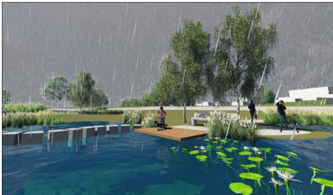
Figur 7. Illustrasjon av fordrøyningsdammen ved stor regnhendelse der flere av fordrøyningsarealene er fylt.
