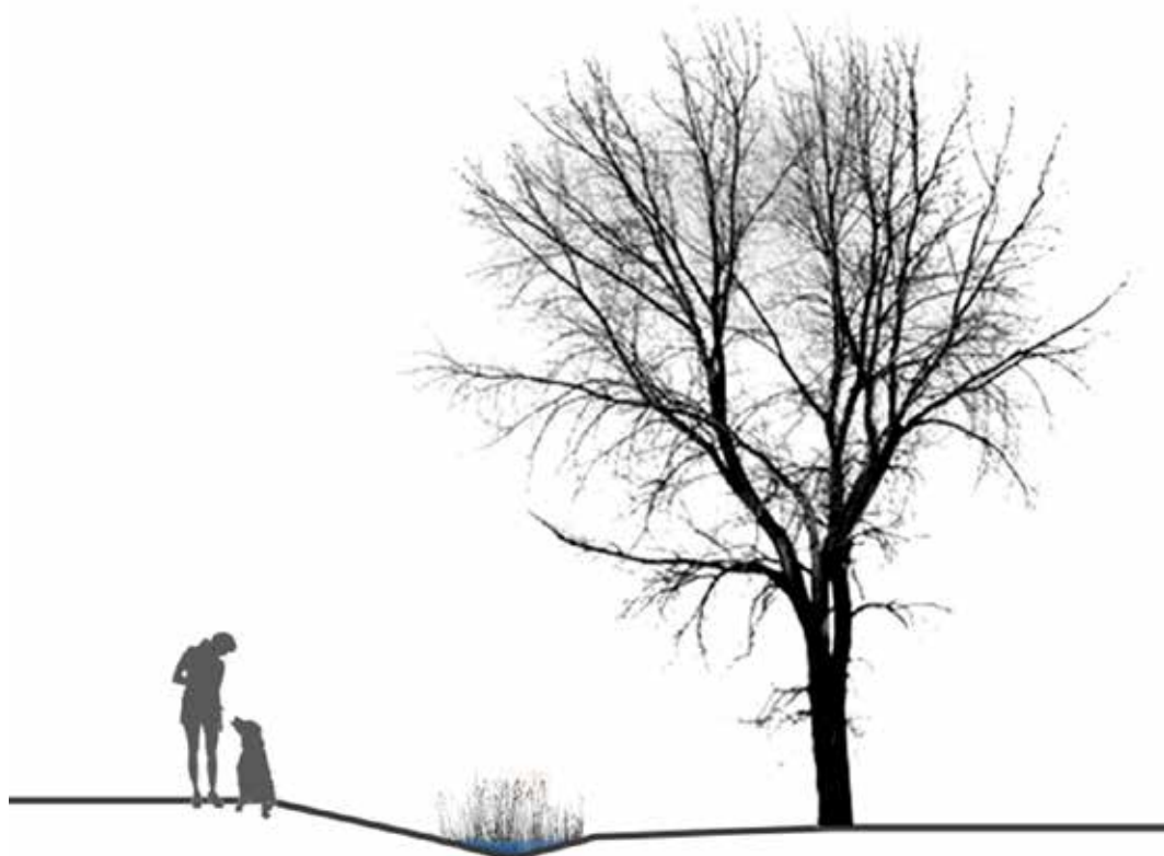
Figur 4. Snitt av grøft som fungerer som flomvei.
