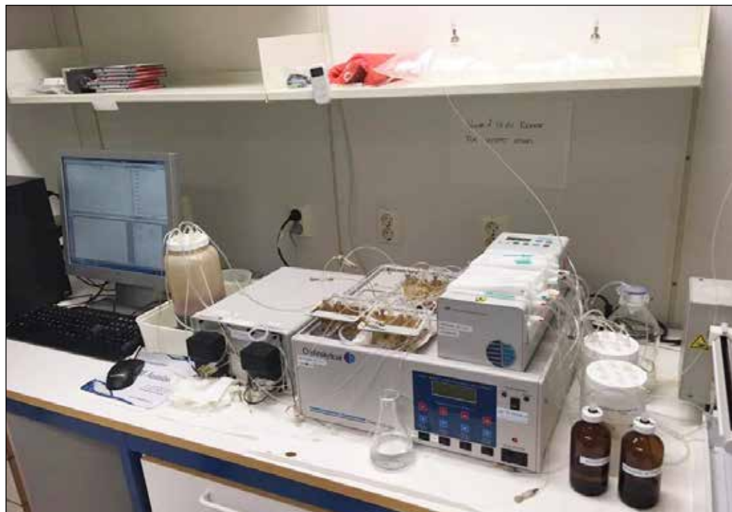
Figur 3: Bildet viser oppsettet av analyseapparat for total fosfor hos analyselaboratoriet Labora AS.
