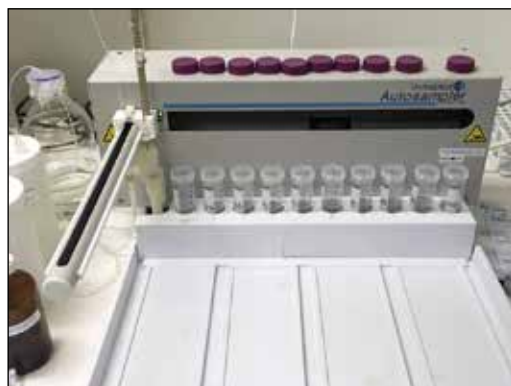
Figur 4: Bildet viser resten av oppsett for analyseapparat for total fosfor.
