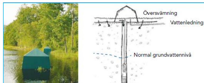
Oversvømmelse av brønnhus. Dricksvattenforsörjning i förändrat klimat (Svenskt Vatten 2007).
