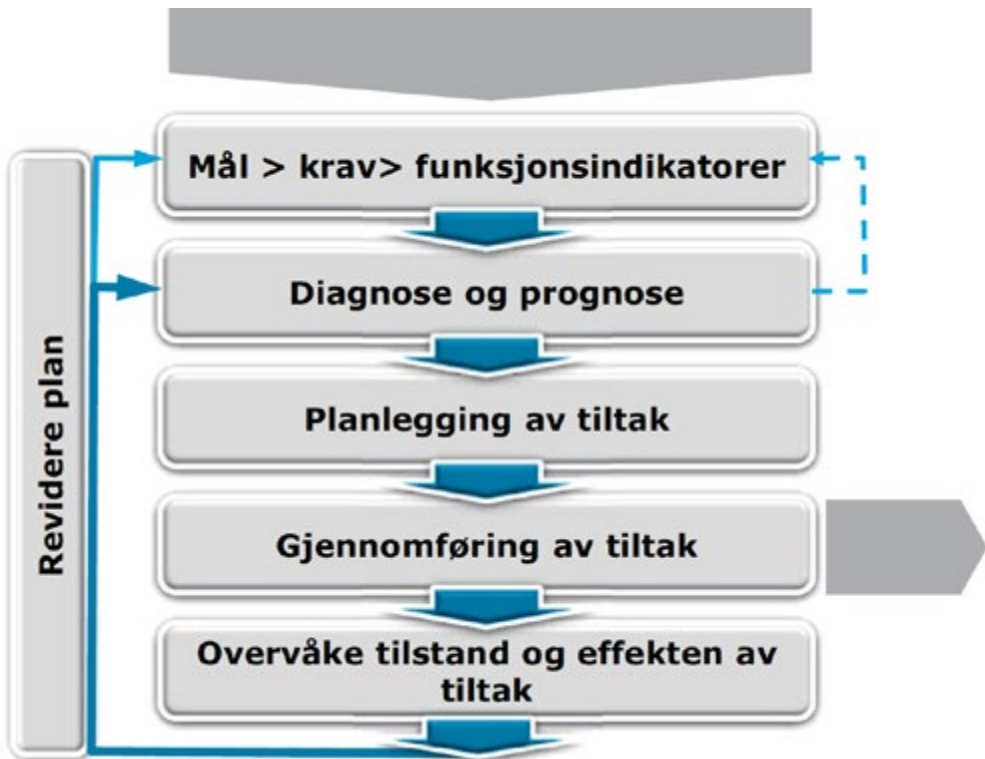
Figur 3. Prosessflyt i eit planleggingsnivå (strategisk, taktisk, operativt). Frå Norsk Vann 196/2013 – Veiledning i tilstandskartlegging og fornyelse av VA-transportssystemer (Røstum et al., 2013).
