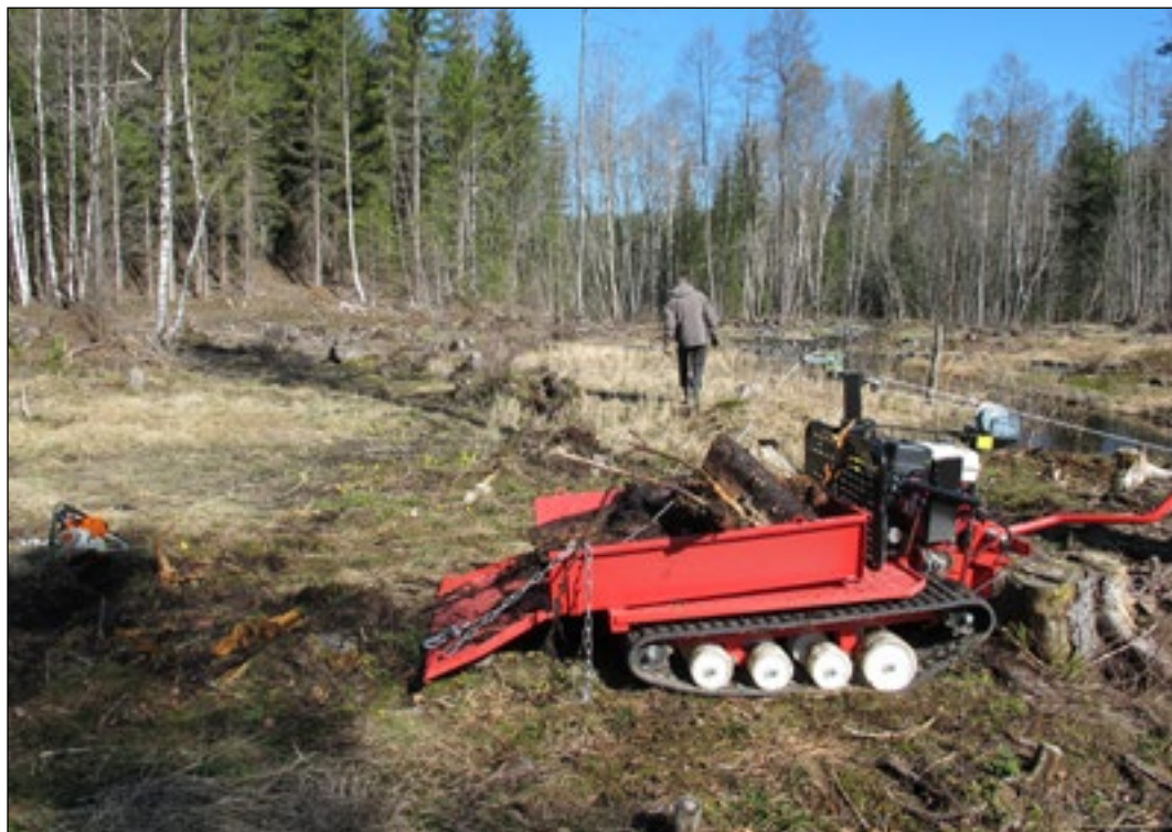
Figur 11. Fjerning av stubber på myra ved bruk av jernhest og vinsj. Foto: Pål Martin Eid.
