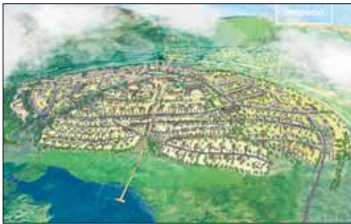
Figur 4. Illustrasjon av bebyggelsesplanen i Urridaholt, med grønne arealer langs gater og åpne områder er brukt for å lede overvannet ned i grunnen. Det som ikke infiltrerer blir ledet fordøyd og kontrollert ned til Urridavatn nedenfor, Alta hf (2013).
