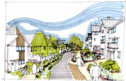
Figur 4. Illustrasjon av bebyggelsesplanen i Urridaholt, med grønne arealer langs gater og åpne områder er brukt for å lede overvannet ned i grunnen. Det som ikke infiltrerer blir ledet fordøyd og kontrollert ned til Urridavatn nedenfor, Alta hf (2013).
