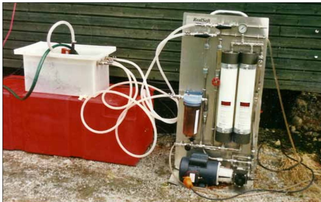
Figur 5. RO-utstyr for isolering av humus/NOM i felt. Dette utstyret kan fraktes frem til vannkilden.
