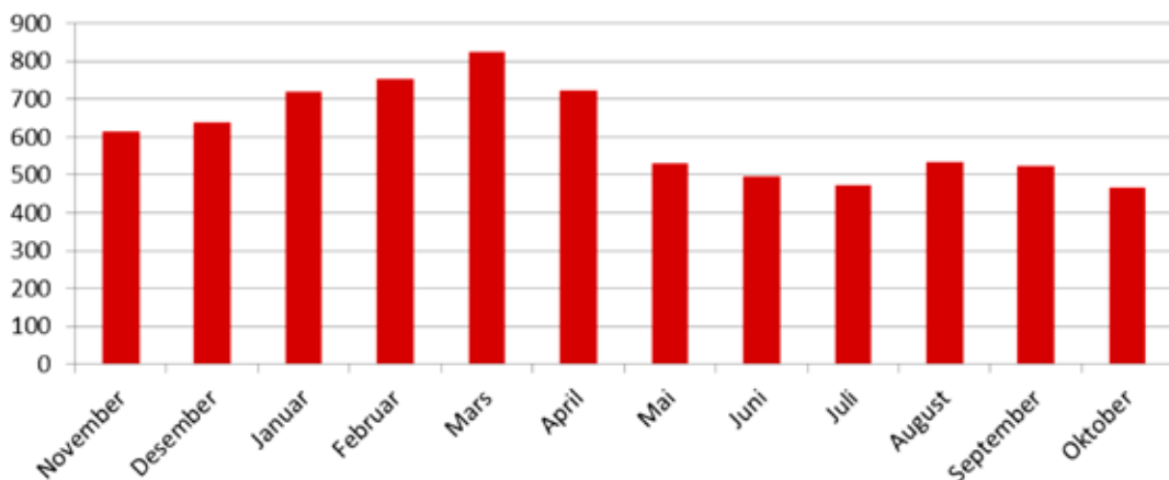
Figur 2. Brudd på kommunale drikkevannsledninger i Oslo, fordelt på månedene.
