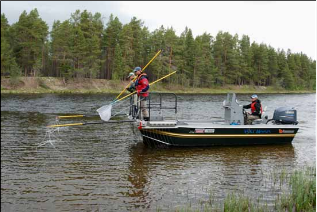
Bilde 1. Den største av elfiskebåtene til NINA. Model 18 EH med 200 hk vannjetmotor (foto: Jon Museth).
