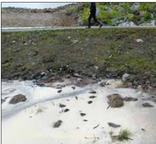
Figur 3. Hvite utfellinger av aluminiumhydroksysulfat nedstrøms deponiene M17 (venstre) og M20 (høyre).
