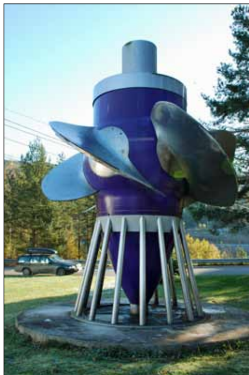
Bilde 1. Stor Kaplan-turbin fra Hunderfossen kraftverk i Gudbrandsdalslågen. Lang avstand mellom rotorbladene gir relativt lav dødelighet for fisk som passerer turbinen. Foto: M. Kraabøl.
