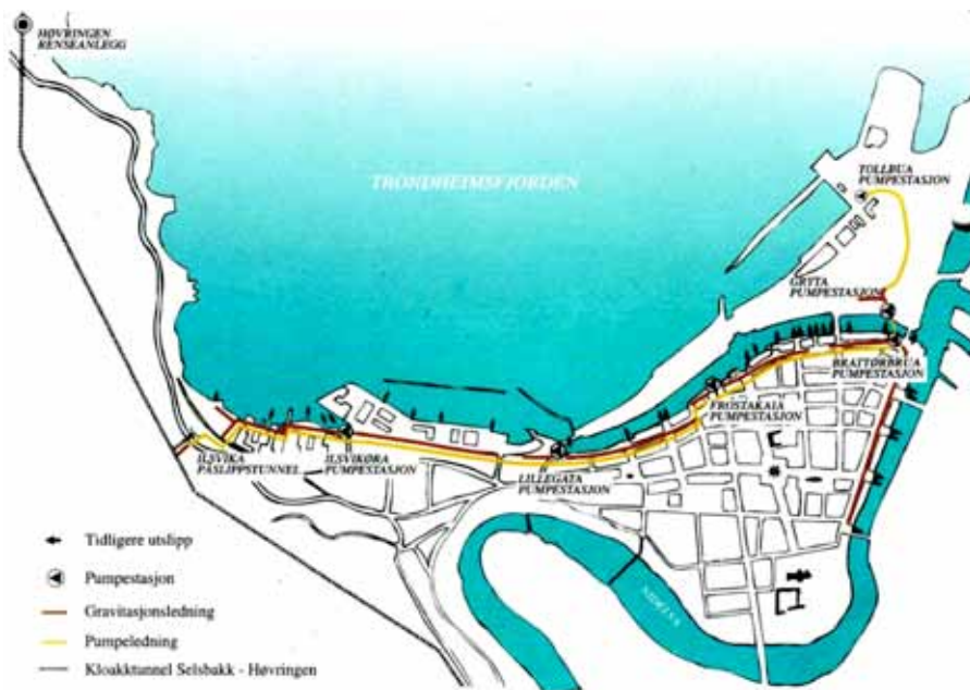
Avskjærende avløpssystem langs kanalen i Trondheim
