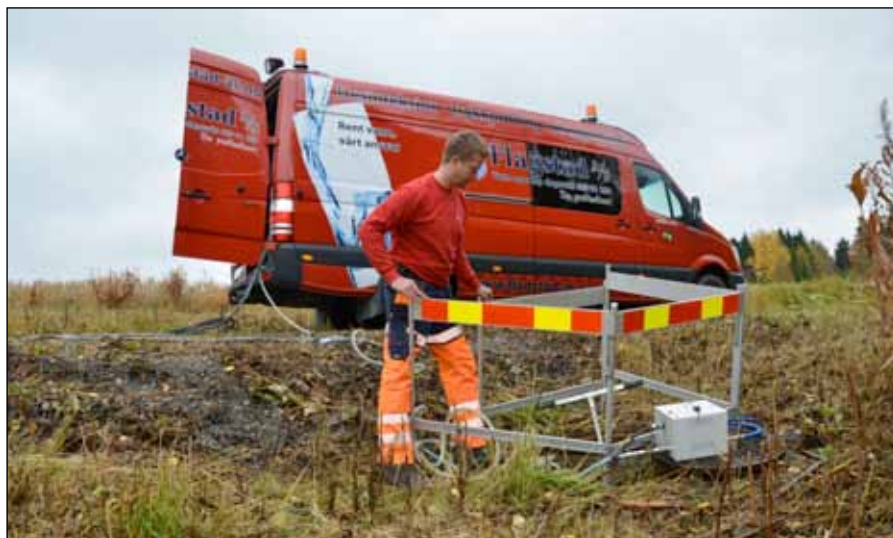
Foto: Stein Linholt i Flagstad as i full aktivitet med trykkprøving av et nyanlegg.
