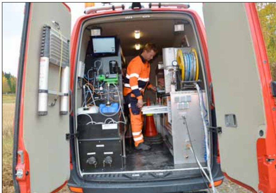
Foto: Trykkprøvingsbilen er en avansert arbeidsplass med helautomatisert utstyr for kvalitetskontroll av vannledninger.
