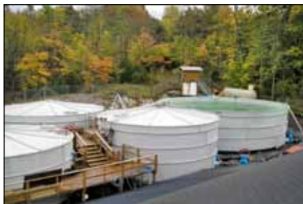
Figur 1. Bilder av NIVAs landbaserte anlegg for testing av renseteknologi for ballastvann: fullskala (venstre), pilotskala (høyre). Foto: Joachim Tørum Johansen.
