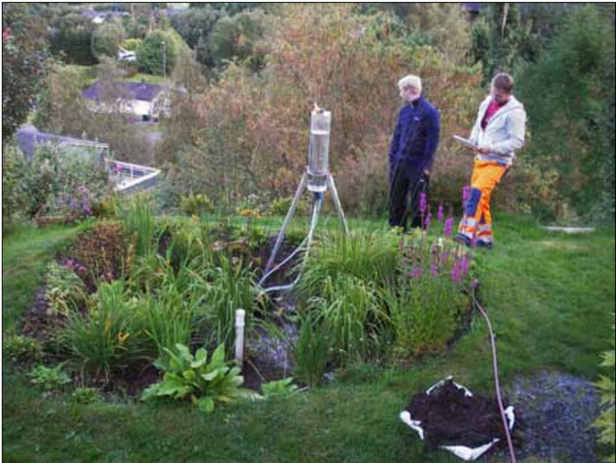
Figur 3. Infiltrasjonsmåling med infiltrometer i regnbed H8. Foto: B.C. Braskerud.
