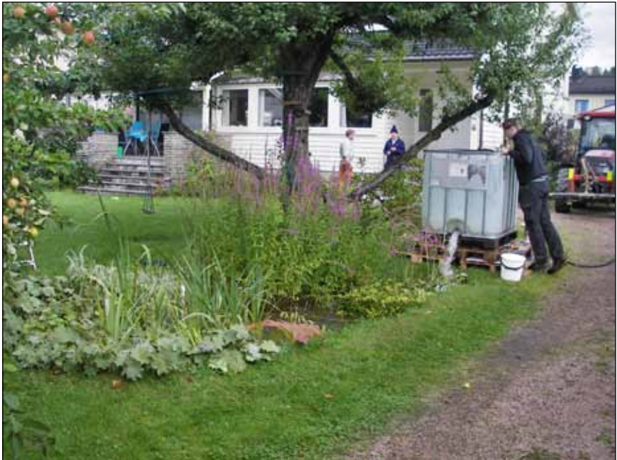
Figur 2. Feltforsøk i regnbed NB21, kunstig nedbør tilføres kontrollert fra container. Foto: B.C. Braskerud.
