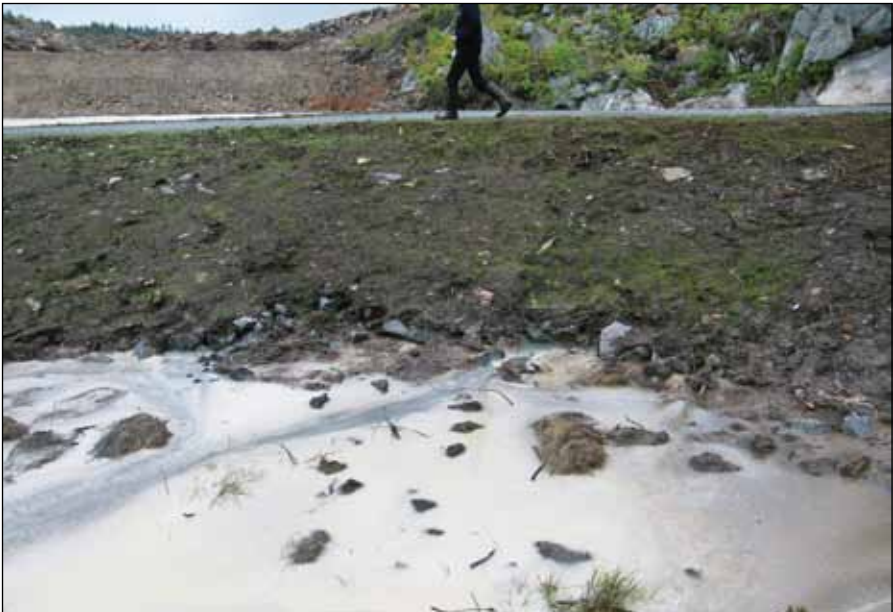
Figur 3. Avrenning fra deponi med sulfidholdig sprengstein (over). Utfelling av aluminiumhydrokysulfat som fester seg på vegetasjon og andre overflater deriblant fiskegjeller (under) (Foto: Atle Hindar, NIVA).
