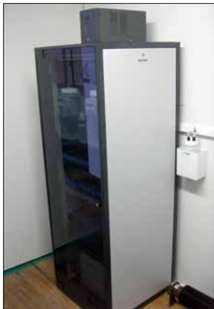
Figur 7. Et CALM-instrument i Polen som måler graden av fekal forurensning i et større reservoar og rekreasjonsområde.
