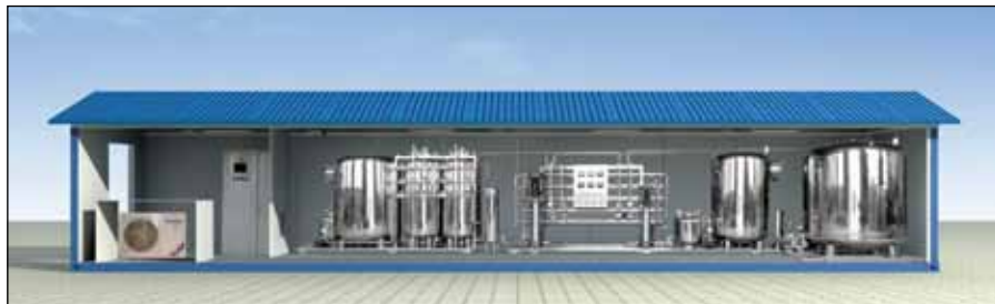
Figur 1. Det omtalte containerbaserte vannbehandlingsanlegget.
