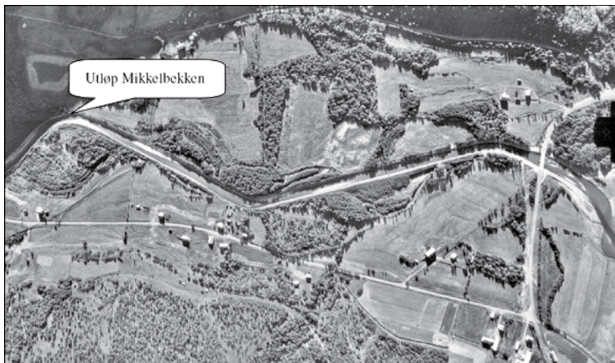
Figur 2. Utsnitt av Bognelvas nedre deler i 1972, kanaliseringsarbeidene langs den nederste delen av vassdraget er ferdigstilt, og det opprinnelige elveløpet synes enda godt. Elveløpet fremstår som en kanal uten erosjons- eller sedimentasjonsprosesser.
