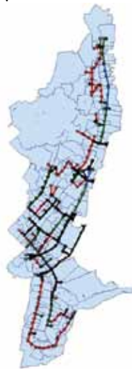
Figur 2. Skjermbilete frå Mike Urban, som viser eit oversiktskart av modellen som er nytta. Blå bakgrunn er nedslagsfelt og delfelt. Raude linjer er kombinertsystem, grønne er spillvassleidningar og svarte er overvassleidningar.
