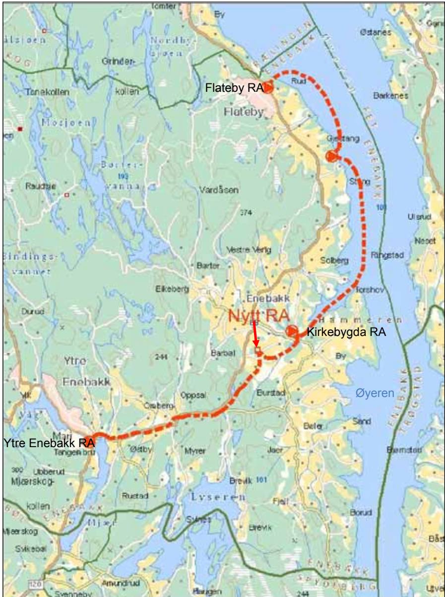
Figur 1. Overføringstrase for avløpsvann fra Ytre Enebakk, Kirkebygda og eventuelt Flateby til nytt sentralrenseanlegg.
