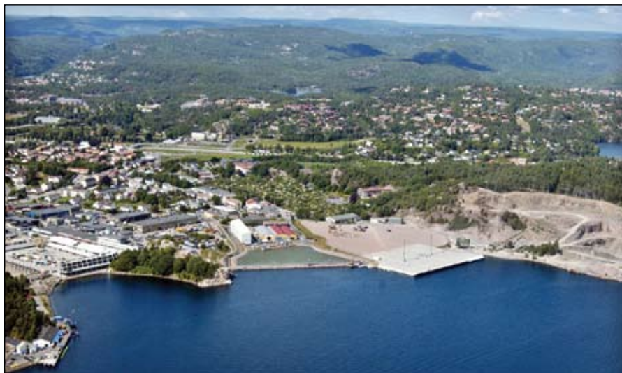
Figur 2. Strandkantdeponiet i Kongsgårdbukta, som er etablert for å motta forurensede sedimenter, sees midt i bildet. Torsvika ligger til venstre, og det tidligere avfallsdeponiet sees like til høyre for strandkantdeponiet. Foto: Tor Kviljo, Terrateknikk.
