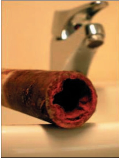
Fig. 2. Et vannrør med blanding av rust og biofilm kan være godt egnet for legionellavekst (foto: Bjørn Eivind Løfsgaard, FHI)
