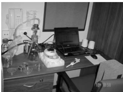
Figur 2. Oppsett for filtrering av bakteriologiske prøver ombord på M/V Aida.
