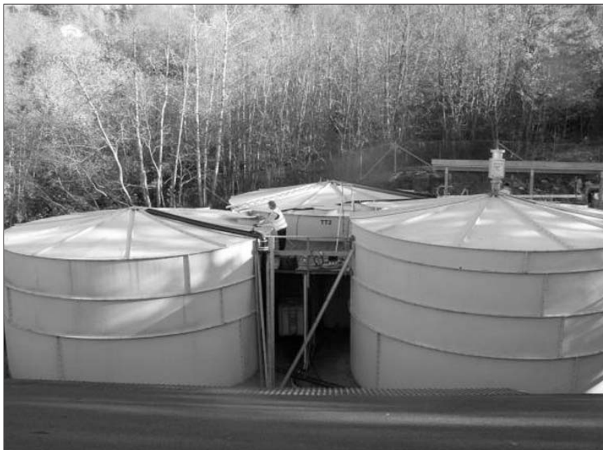
Figur 1. Tanker for lagring av inntaksvann, behandlet vann og kontrollvann ved landbasert testing av behandlingsteknologier for ballastvann.
