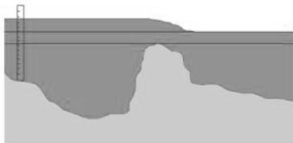
Figur 3. Oppstuvning nedstrøms kulpen. Vannføring kan ikke beregnes vha kun vannstand pga mottrykk nedstrøms terskelen
