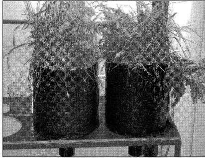
Figur 2. Søyleforsøk hvor effekten av planter på nedbrytning av plantevernmidler og næringsalter er undersøkt. Søyler med planter ble sammenlignet med søyler med kun jord, med lav biologisk aktivitet.
