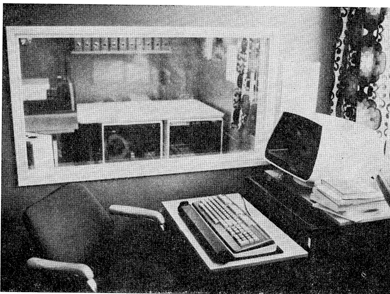
Figur 1. Oversiktsbilde av EDB-anlegget ved ANØ. Anlegget består av skjermtterminal, sentralprosesser, disk, disketttestasjon, båndstasjon og skriver.
