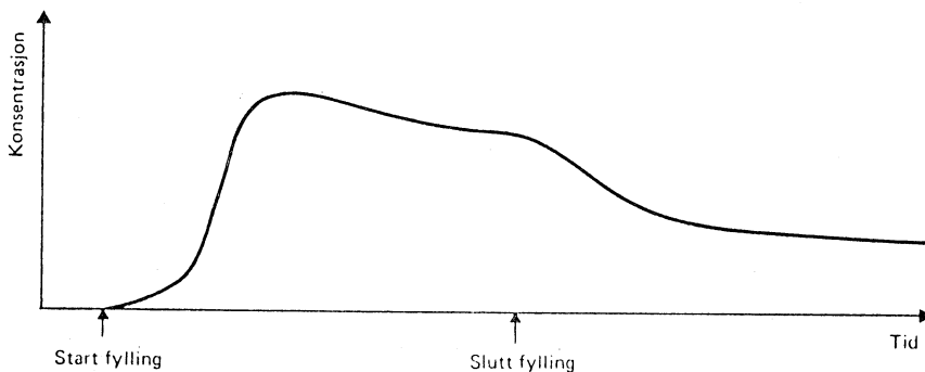
Fig. 3. Forurensningskonsentrasjoner i sivevann fra kontrollert fylling.
